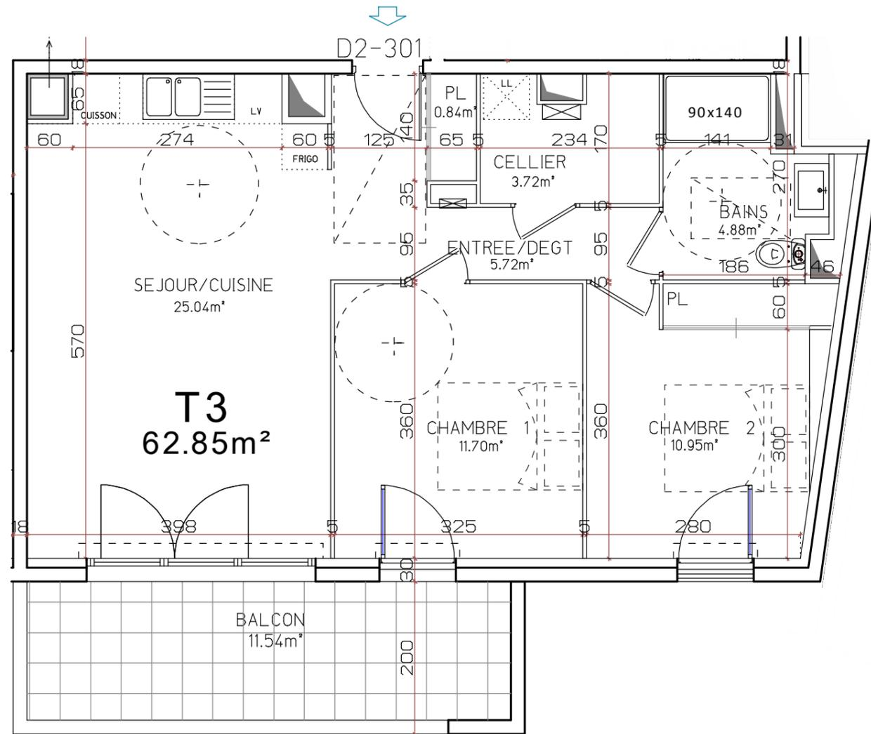
Dimensions minimums imposées pour l'accessibilité handicapés
